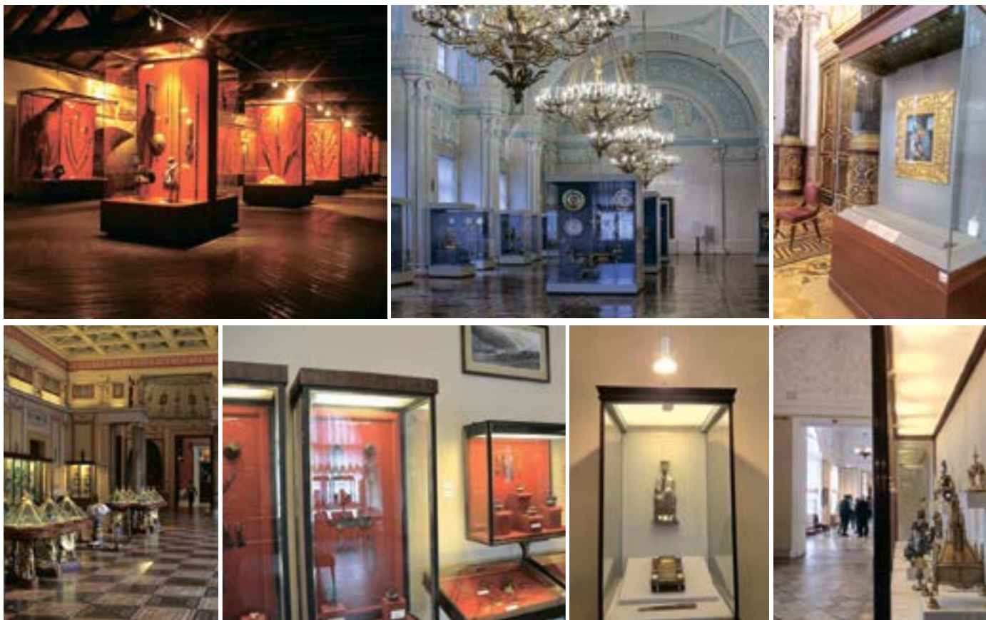
Варианты освещения витрин. а, е) через прозрачную верхнюю панель, б) внешними осветительными приборами через боковые стены витрин, в) встроенными в витрину разнонаправленными осветителями, г, д, ж) встроенными в верхнюю панель осветителями
