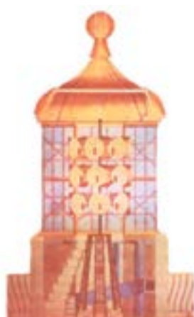
Маяк с 15 зеркальными элементами
