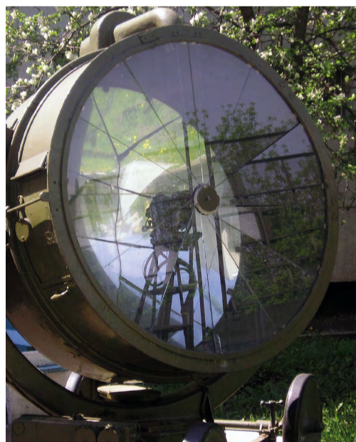
Зенитный прожектор З-15-4Б образца 1939 года. Диаметр отражателя – 150 см, дальность освещения цели – 7-9 км
