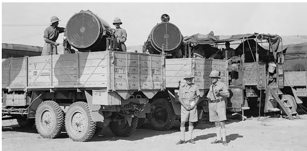
Английские зенитные прожектора 90-см, установленные в кузовах грузовиков
