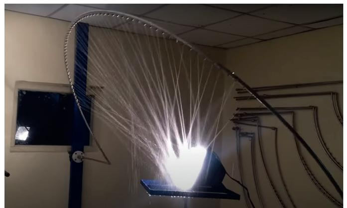
Рисунок 2. Проверка светильника на IPX5
