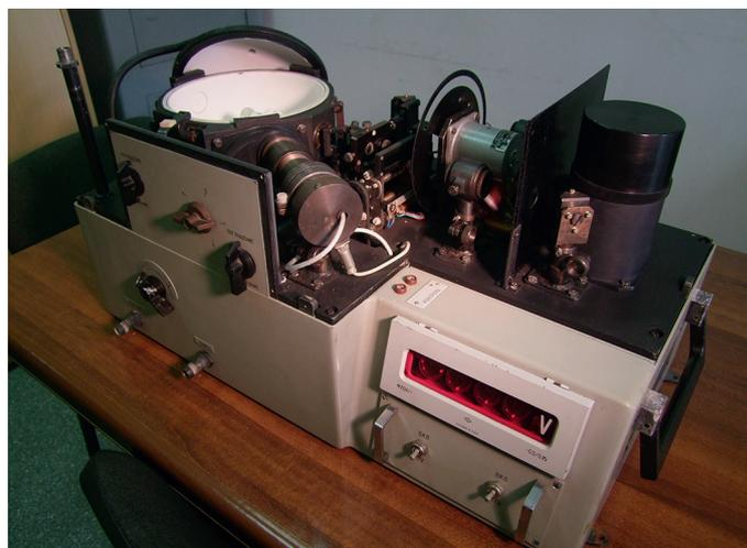
Рисунок 3. Внешний вид прибора (со снятой крышкой) ИППР-1 для измерения показателя поглощения и рассеяния
