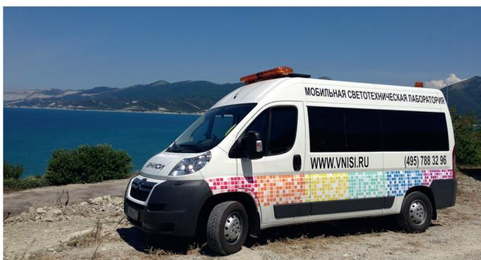
Рисунок 7. Мобильная светотехническая лаборатория для измерения яркости дорожного полотна
