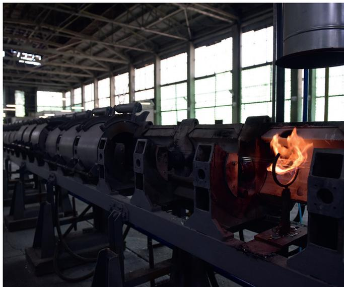
Рисунок 8. Протяжка трубки из увиолевого стекла
