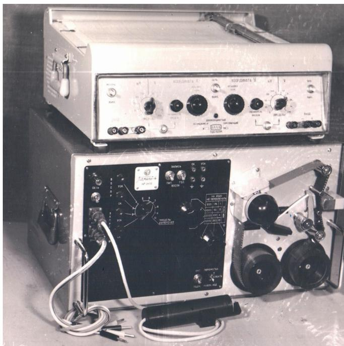
Рисунок 2. Внешний вид прибора Память-4 для измерения разгона электродвигателей
