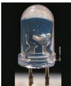
Светодиод в пластмассовом корпусе
