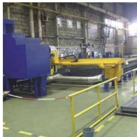
Машина термической резки
