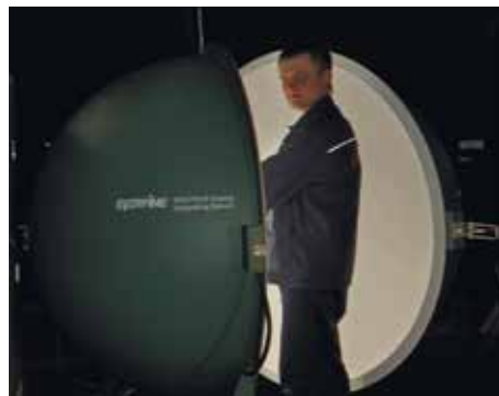
Испытательный центр, фотометрический шар для измерения светотехнических параметров световых приборов
