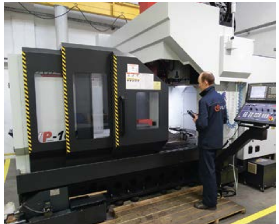
3,5-координатный фрезерный обрабатывающий центр с ЧПУ VP-1612 для расширения возможности обработки более габаритных пресс-форм
